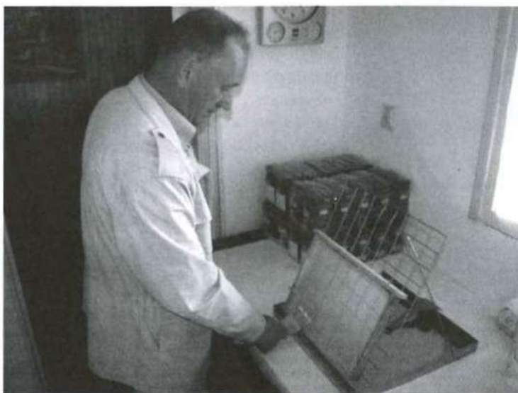
Przygotowanie pasieki, opieka nad pszczołami to nie wszystko. Do produkcji miodu potrzebne jest jeszcze odpowiednie zaplecze ze specjalistycznym sprzętem, m.in. miodarka, w której odwirowuje się ramki z plastrami miodu.
