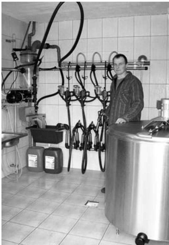
Jan Sondej w pomieszczeniu ze schładzalnikiem i urządzeniami dojarki przewodowej.
