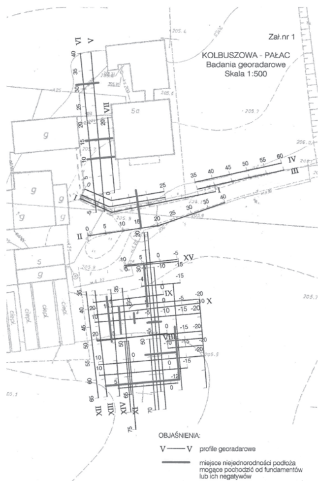
RYC.5. WYNIKI BADAŃ NIEINWAZYJNYCH PRZEPROWADZONYCH W 2005 ROKU NA TERENIE PAŁACU LUBOMIRSKICH W KOLBUSZOWEJ Z ZASTOSOWANIEM GEORADARU. CZERWONE ODCINKI OZNACZAJĄ MIEJSCA NIEJEDNORODNOŚCI PODŁOŻA WSKAZUJĄCE FUNDAMENT LUB JEGO NEGATYW.
